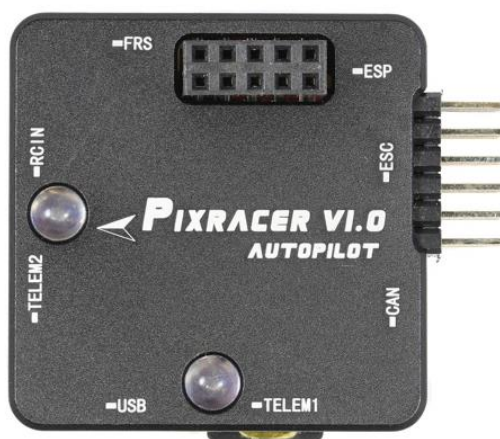
Внешний вид полетного контроллера Pixracer V1.0
